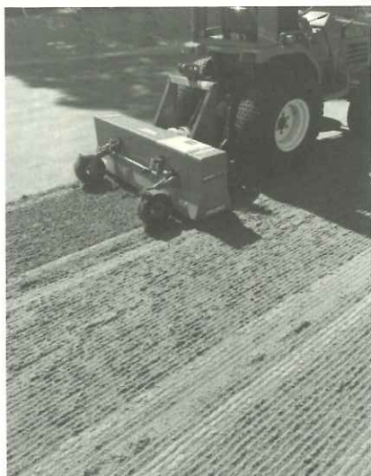
「サッチカッター」でグリーンのサッチを掻き出して除去。透水性が向上した
